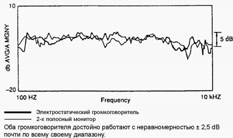
Рисунок 50. Оба громкоговорителя достойно работают с неравномерностью \pm 2,5 dB почти по всему своему диапазону.
