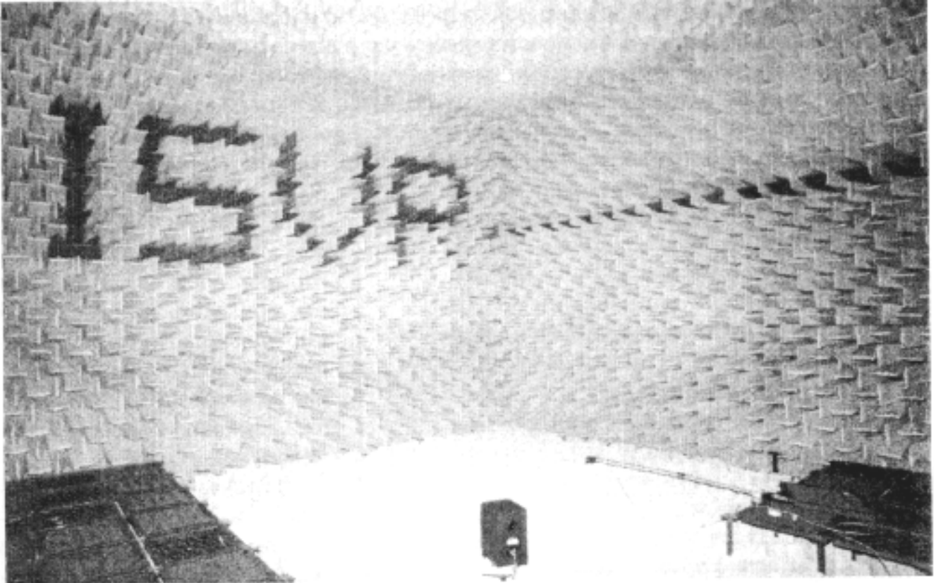
Фото 22. Безэховая камера «ISVR». Большая безэховая камера в Институте Исследования Звука и Вибрации Саутгемптонского университета в Великобритании имеет объем 611 \text{ м}^3 . Она является безэховой до частоты примерно 70 \text{ Hz} . Ниже этой частоты длина пикансонов составляет менее четверти длины волны ( 70 \text{ Hz} ), поэтому степень поглощения начинает резко падать. Решётки пола полностью снимаются, но они достаточно прочны, чтобы выдержать даже вес автомобиля.
